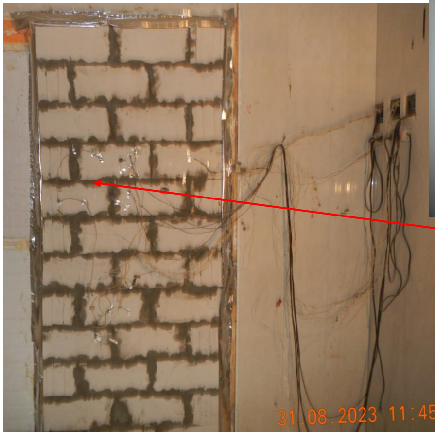
Фото 1а,б. Фрагмент кладки рег. № 4871-1-23 из блоков силикатных пустотелых СБПу-М150/А75/1,4 размером 390х190х188 в климатической камере (теплая сторона)
