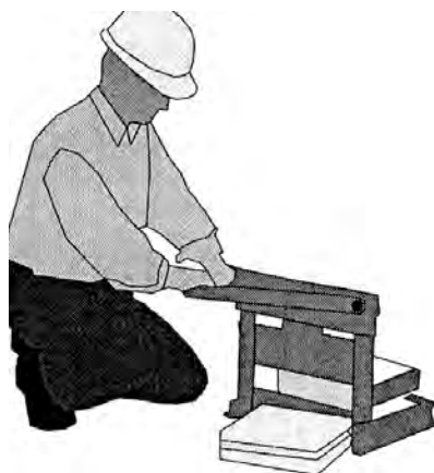
Рисунок 23 – Изготовление дополнительных элементов с помощью гильотины
