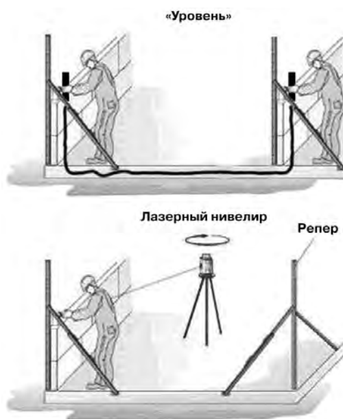
Рисунок 25 – Установка шаблонов углов с помощью шлангового ватерпаса и лазерного уровня
