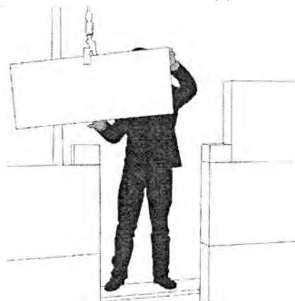
Рисунок 43 – Укладка полноразмерного блока с помощью крана малой грузоподъемности
