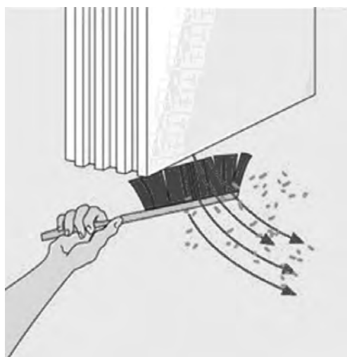
Рисунок 32 – Очистка от грязи и пыли поверхности укладываемых блоков
