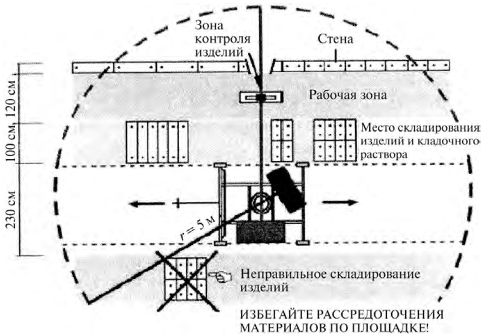
Рисунок 45 – Организация рабочего пространства при использовании кранов малой грузоподъемности
